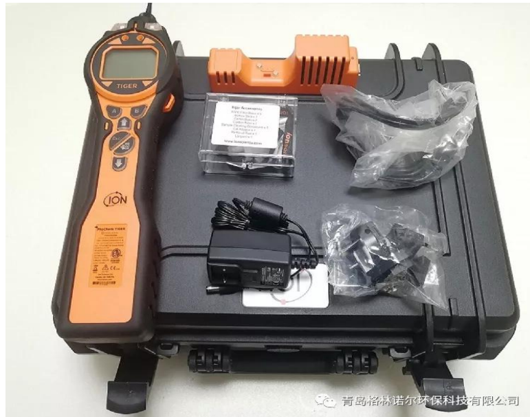
图 2.3.1-2 PhoCheck Tiger 虎牌 VOC 检测仪
